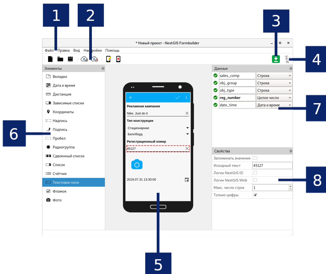
Рис. 2.1: Внешний вид интерфейса приложения Formbuilder. Цифрами обозначено: 1 - главное меню; 2 - панель инструментов; 3 - маркер наличия обновлений; 4 - кнопка авторизации; 5 - «экран устройства»; 6 - меню «Элементы»; 7 - меню «Данные»; 8 - меню «Свойства».
